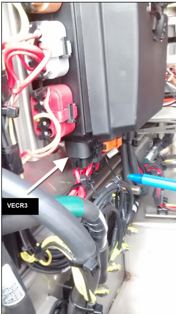
FIGURE 25 : BOÎTE DE JONCTION ARRIÈRE.
